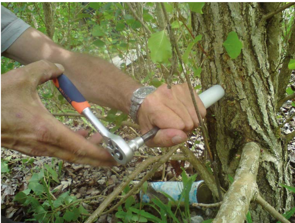
Réalisation d'un prélèvement pour phytoscreening.
