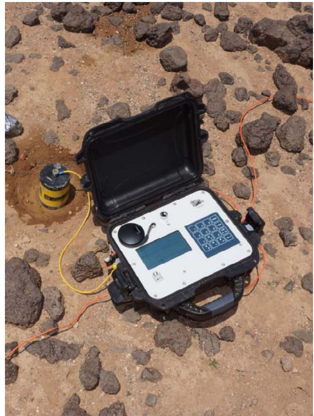
Électrode impolarisable reliée à un récepteur permettant des mesures de séries temporelles.
