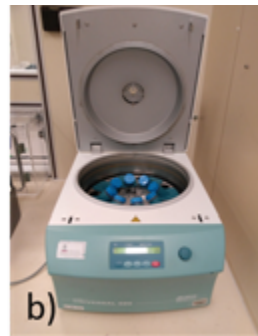
Etapes de traitement des échantillons : a) Extraction avec des solutions digestives à 37°C, b) centrifugation, c) analyse par ICP-MS.
