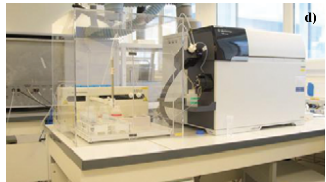
Étapes de traitement des échantillons : a) tamisage à 250 µm, b) ajout d'une solution d'HCl, c) agitation par ultrason et chauffage à 37 °C, d) dosage par spectrométrie de masse.
