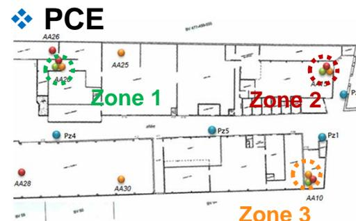
➤ résultats cohérents entre le Gore Sorber Module et le BeSure Sampler dans des zones aux niveaux de contaminations différents, et pour différents contaminants majeurs du site (PCE, TCE, cis-DCE)
