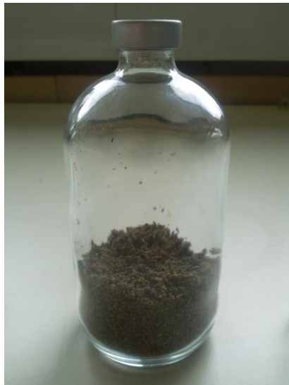
Microcosme de sol en flacon étanche utilisé pour l'étude en laboratoire
