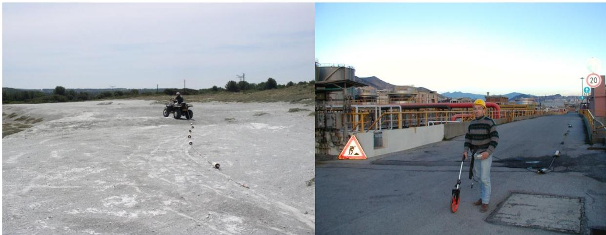
Figure 40 : Photos du OhmMapper en action, tiré par un quad ou par un opérateur. Le récepteur est situé en queue du dispositif et les 4 récepteurs en tête.
