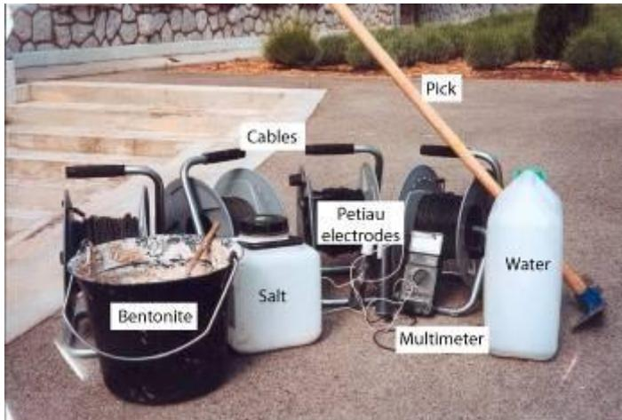
Figure 43 : Equipement de potentiel spontané : les électrodes, le multimètre, les câbles, eau, sel et bentonite pour améliorer le contact électrique des électrodes si nécessaire
