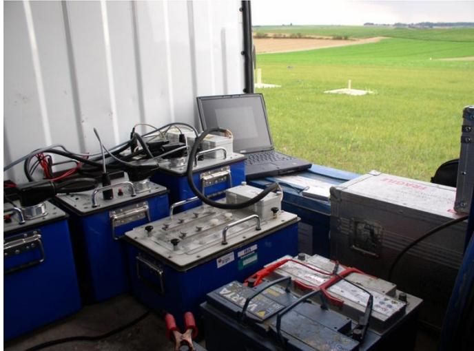
Figure 53 - Équipement de Résonance Magnétique Protonique « NUMIS<sup>+</sup> » sur site.
