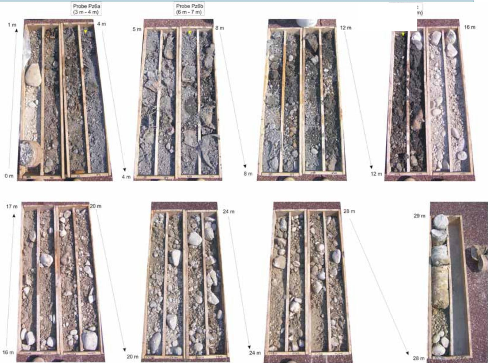
*Présentation des carottes de sondage dans leurs caisses à carotte d'un sondage au carottier battu*
