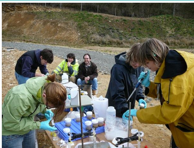
Lixiviation des échantillons sur site et séparation des solutions sur résine pour détermination de la spéciation de As
