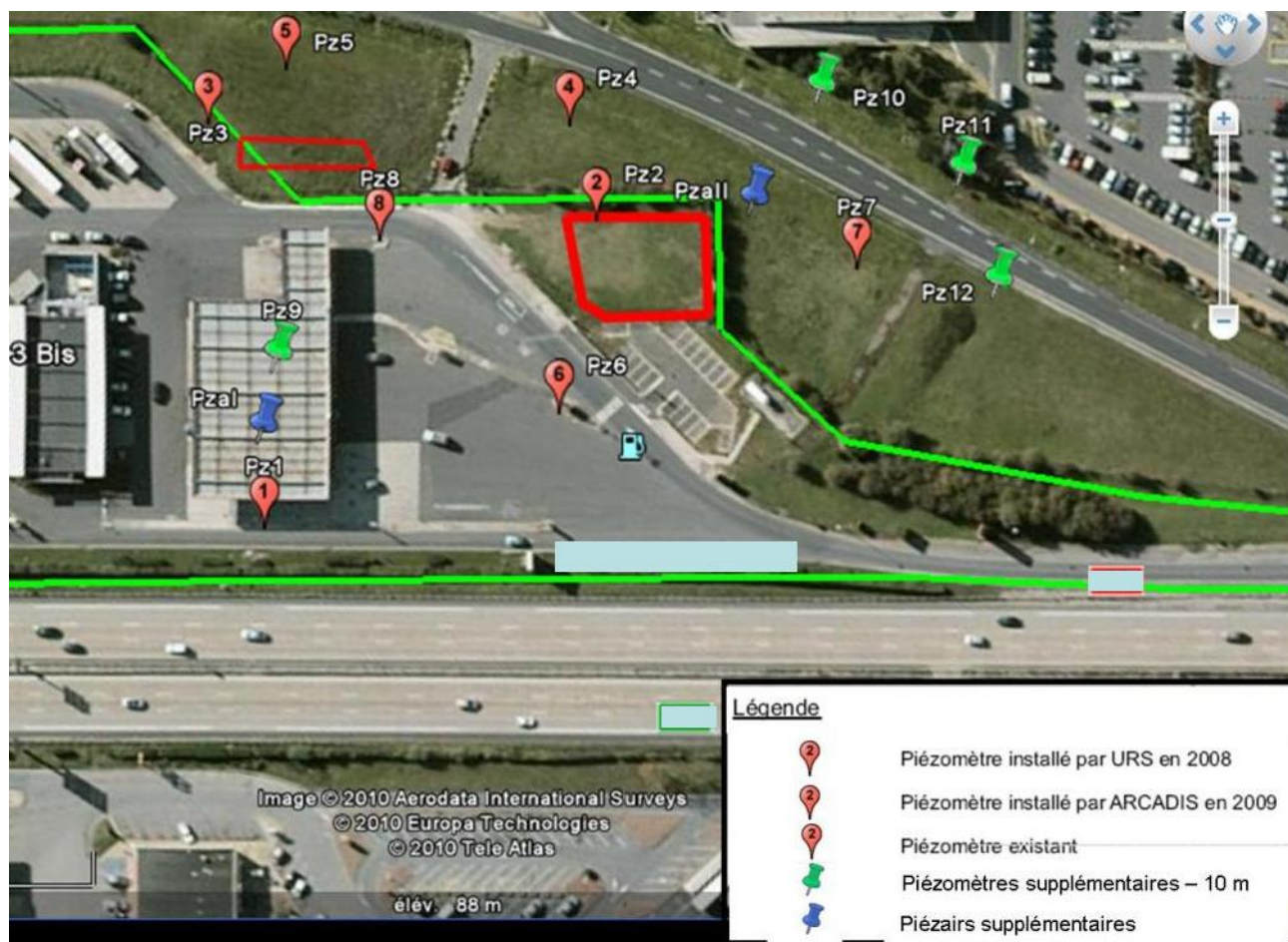
Figure 26 : Localisation des ouvrages de surveillance (2010, site 3bis)
