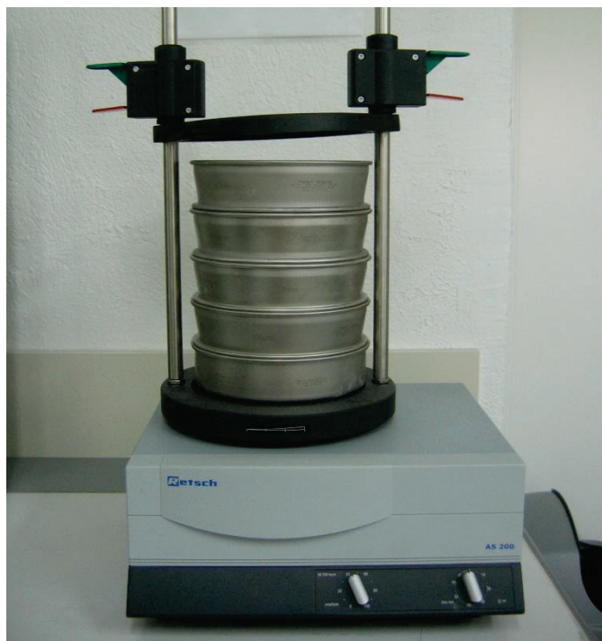
Figure 5 : Exemple de dispositif pour la détermination de la granulométrie d'un sol par tamisage à sec
