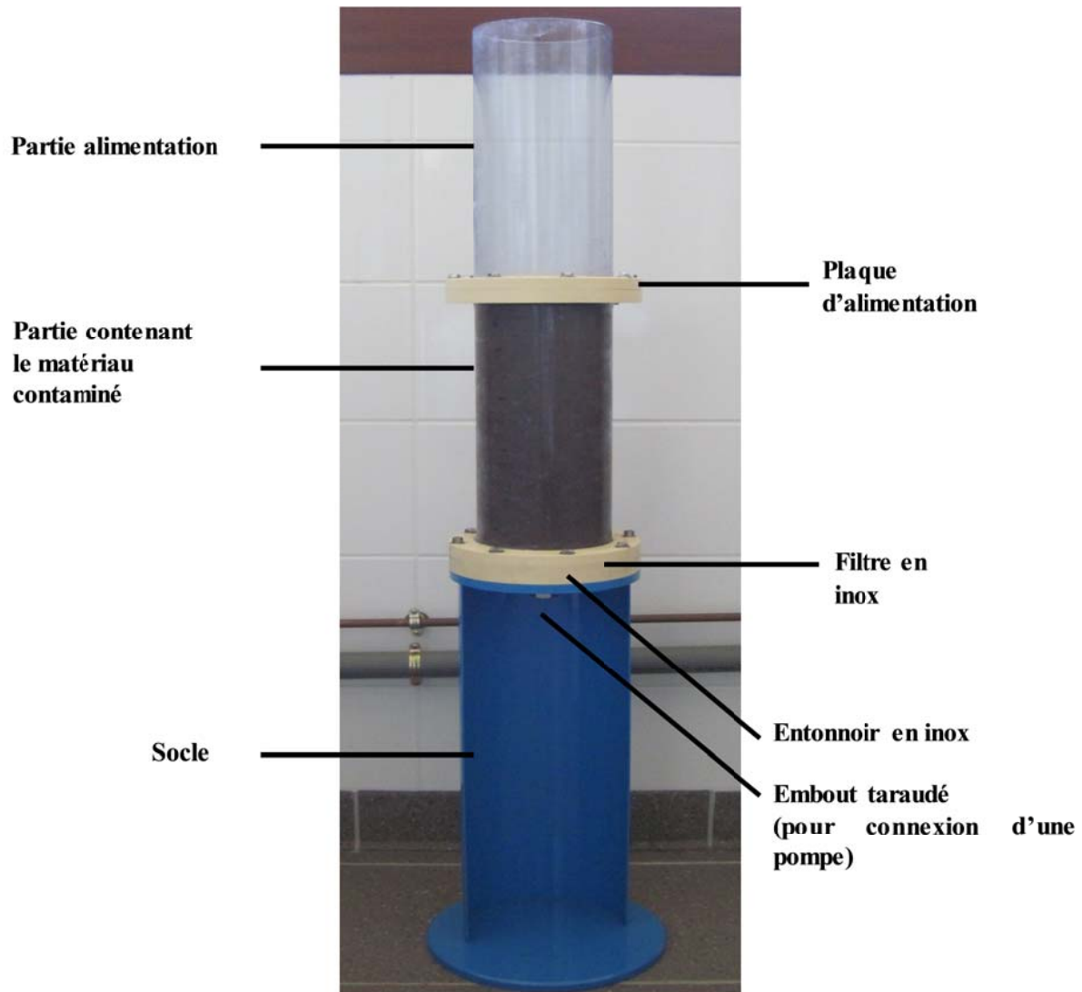
Figure 2 - Colonne utilisée pour les expériences d'infiltration d'eau de pluie
