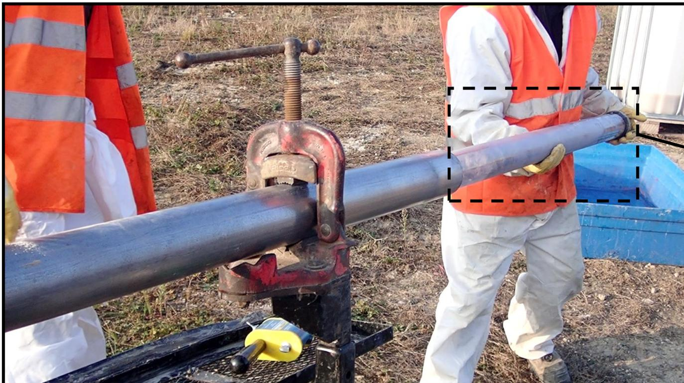
Carottier métallique (à gauche) et gaine PEHD ou liner (L)
