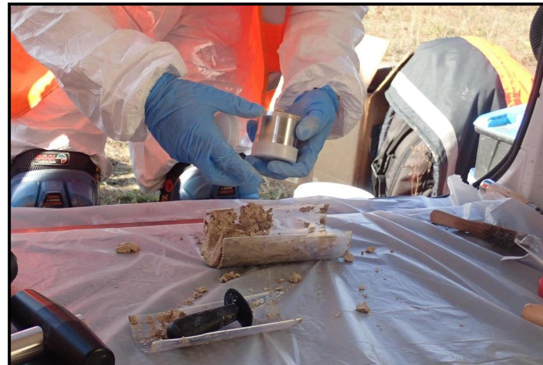
Grand cylindre (CG) : mise en place des bouchons
