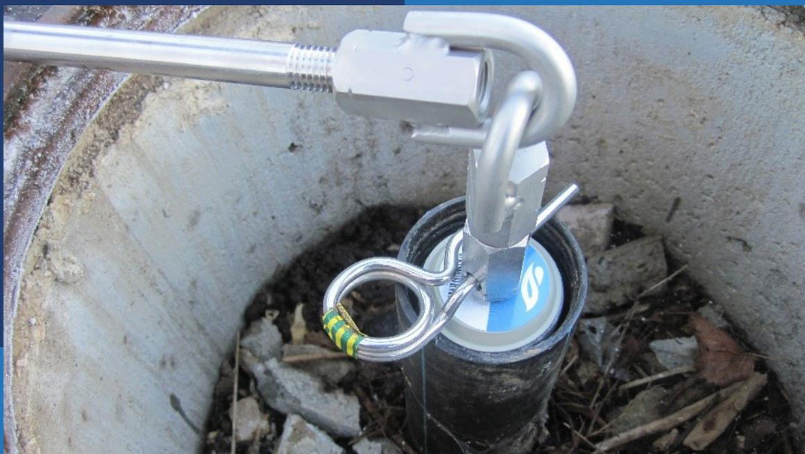
Figure 2 : Mise en place des échantillonneurs iFLUX
