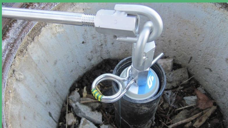
Figure 2 : Mise en place des échantillonneurs iFLUX
