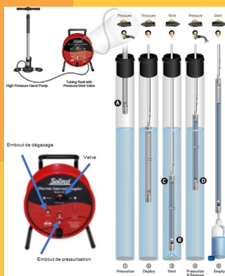
Figure 2 : Montage pour un prélèvement avec le préleveur bas débit entre obturateurs
