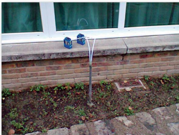
*Une canne de mesure est positionnée dans le trou pour prélever l'air.*
