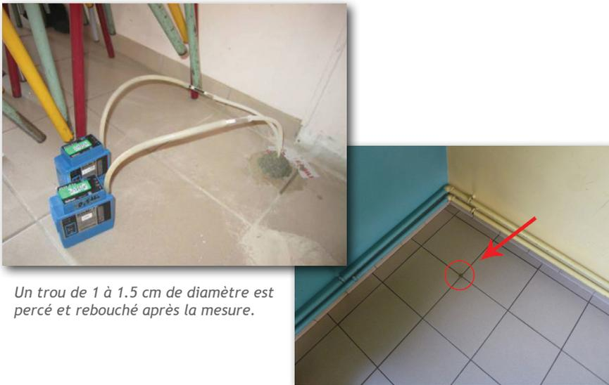
*Un trou de 1 à 1.5 cm de diamètre est percé et rebouché après la mesure.*
