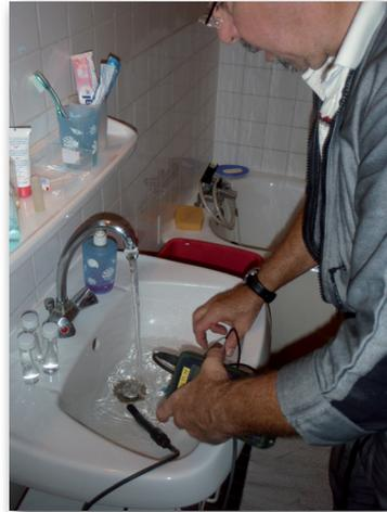
L'eau du robinet est recueillie dans des flacons en verre d'un litre. Les mesures sont réalisées sur site à l'aide de sondes portatives plongeantes.
