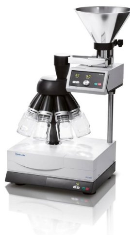
Illustration 12 : Exemple de diviseur rotatif
