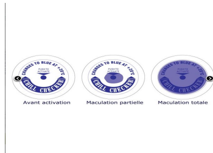
Illustration 9 : Exemple d'indicateur de températures irréversibles : réglette avec curseur indicateur, ou pastille se colorant
