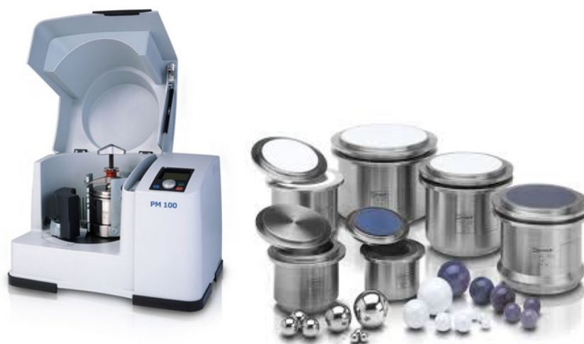
Illustration 14 : Exemple de broyeur à billes.
