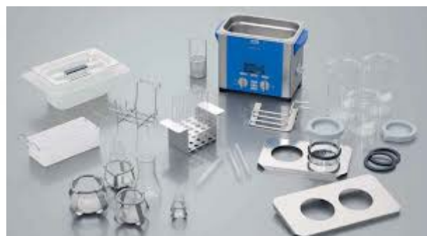
Illustration 20 : exemples de bac à ultrasons pour sonication
