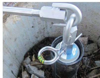
Cartouches iFLUX et installation dans le piézomètre
