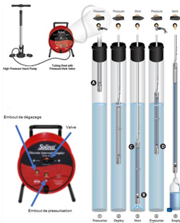
Figure 14 : Echantillonneur sous pression à intervalles discrets, principe de fonctionnement ©Solinst
