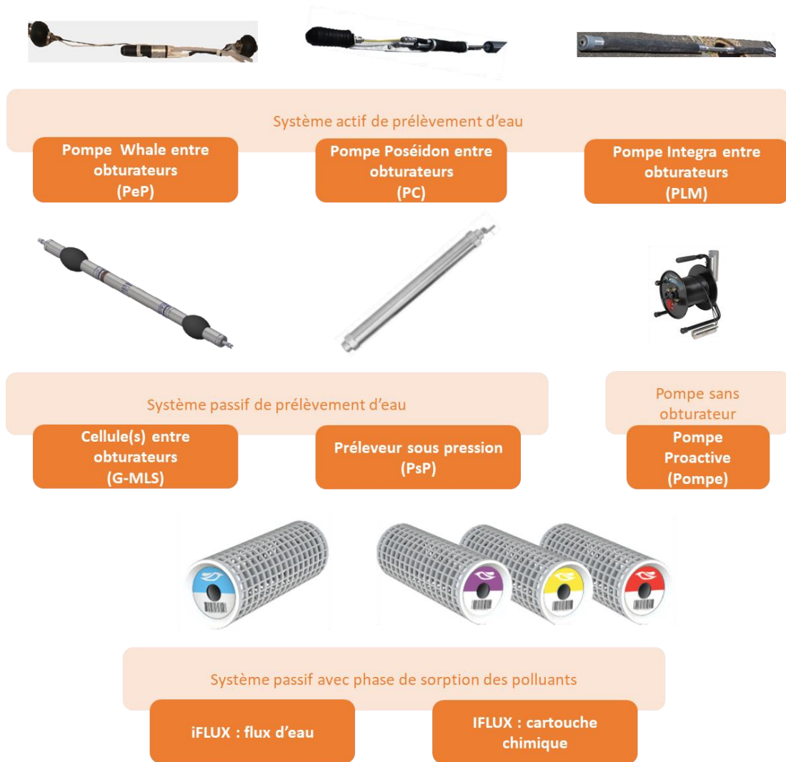
Figure 22 : Photos des outils de prélèvements multiniveaux utilisés et principe de fonctionnement
