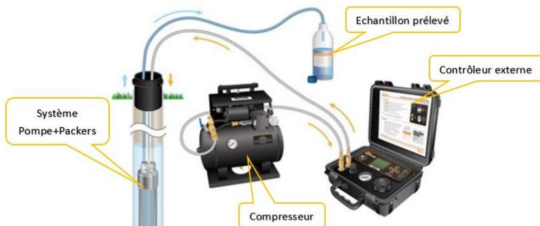
Figure 12 : Préleveur PLM ©BRGM ; ©PLM Services
