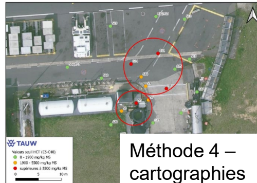
Figure 12 : Délimitation horizontale des impacts (teneurs maximales en HCT C5-C40 dans les sols)
