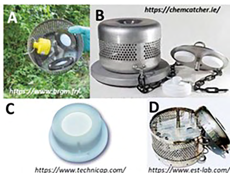
Exemple d'échantillonneurs intégratifs passifs de type A) POCIS, B) Chemcatcher®, C) DGT et D) SMPD avec leurs boîtiers et supports de fixation.
