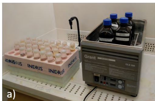
Étapes de traitement des échantillons : a) Extraction avec des solutions digestives à 37°C, b) centrifugation, c) analyse par ICP-MS.
