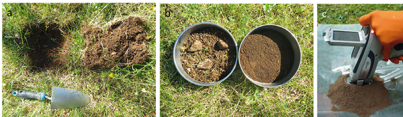
Matériel nécessaire au prélèvement, tamisage et mesure sur site.
