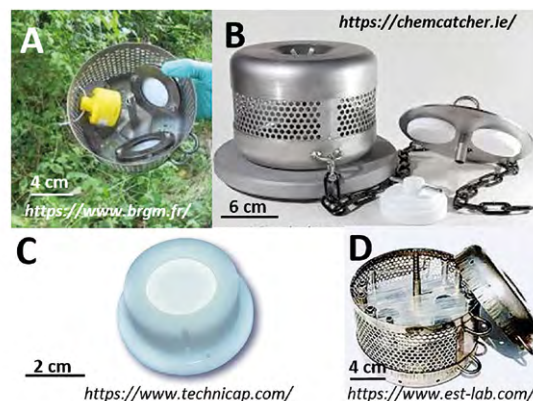
Exemple d'EIP de type A) POCIS, B) Chemcatcher®, C) DGT et D) SMPD avec leurs boîtiers et supports de fixation pour les ESU (voir tableau ci-dessous).
