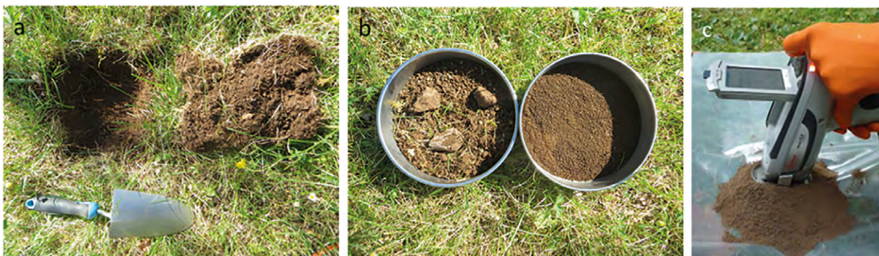
Matériel nécessaire au prélèvement, tamisage et mesure sur site avec la technique pXRF.
