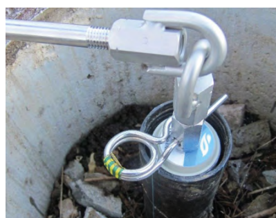
Cartouches iFLUX et installation dans le piézomètre
