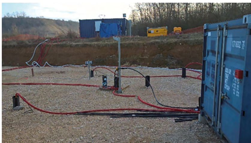
Injection de mousse in situ pour la récupération de DNAPL.
