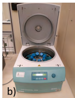
Étapes de traitement des échantillons : a) Extraction avec des solutions digestives à 37°C, b) centrifugation, c) analyse par ICP-MS.
